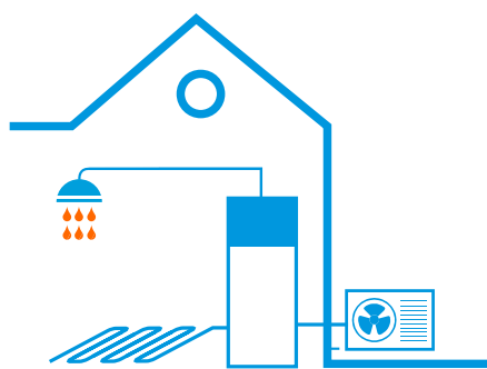
Altherma 3 RF - Vloermodel met geïntegreerde roestvrijstalen warmtapwatertank
