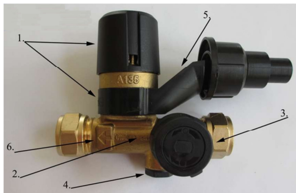
1. Ontlastklep; 2. Terugslagklep; 3. Afsluit. 4. Beproeving aansluiting; 5. Trechter; 6. Stroomrichting. Fig. 8- Inlaat combinatie
